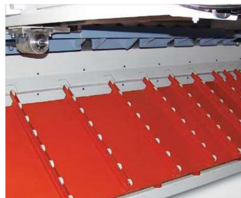
■ Il sostegno lamiera pneumatico "monoblocco" impedisce la discesa di lamiere pesanti e sottili permettendo tagli più precisi (O)
