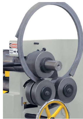
Opsiyonel profil kıvrırma işleri için uzatılmış mil uçları ve vals top takımı Optional extended roll shafts for profile bending operation and section bending rolls set
