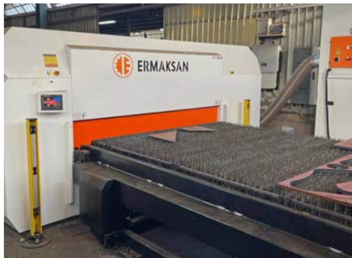
Grazie al cambio pallet di cui è dotato il nuovo impianto di taglio laser Ermaksan, CM De Rose riesce a velocizzare le proprie operazioni: mentre la lavorazione di taglio sulla tavola interna alla macchina prosegue, l'altra tavola può essere scaricata e caricata
