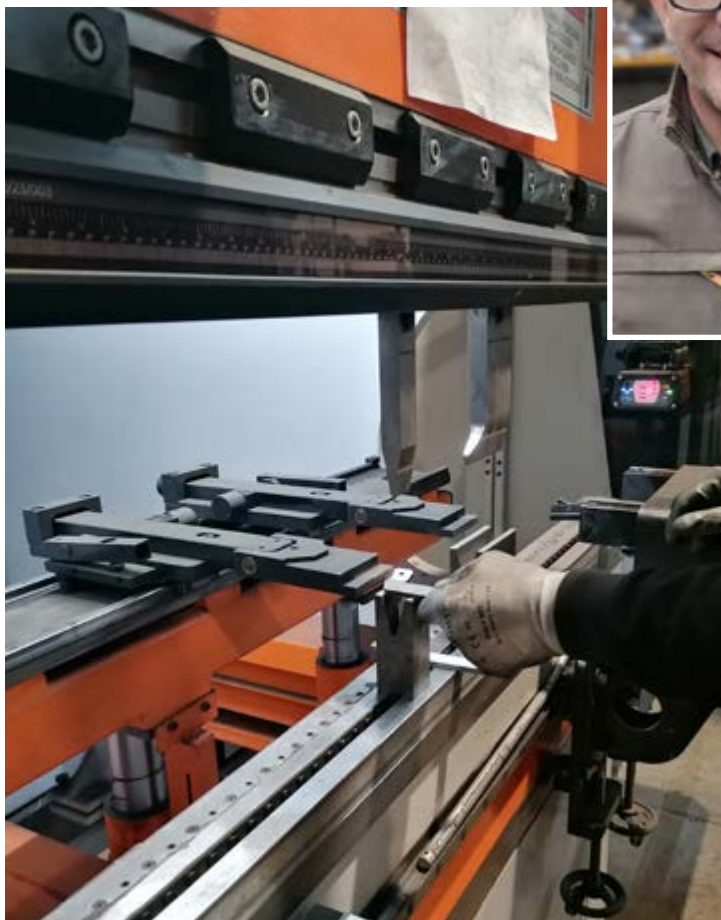
La corsa maggiorata a 300 mm della pressa piegatrice Ermaksan Speed-Bend Pro fornita da Co.Ma.F. consente ad Agrital la piega di sagome anche complesse e di scatolati in lamiera con i bordi alti
