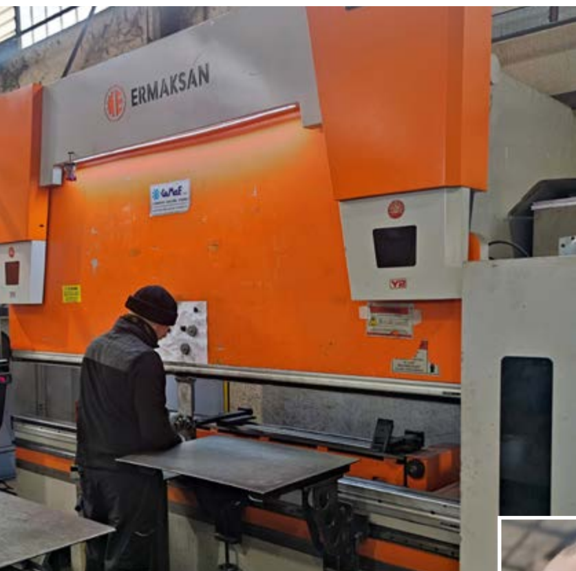
La corsa maggiorata a 300 mm della pressa piegatrice Ermaksan Speed-Bend Pro fornita da Co.Ma.F. consente ad Agrital la piega di sagome anche complesse e di scatolati in lamiera con i bordi alti
