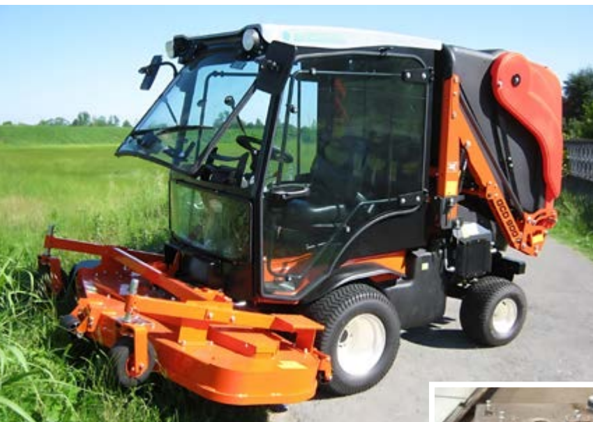
Esempio di cabina omologata realizzata da Agrital per trattori rasaerba
